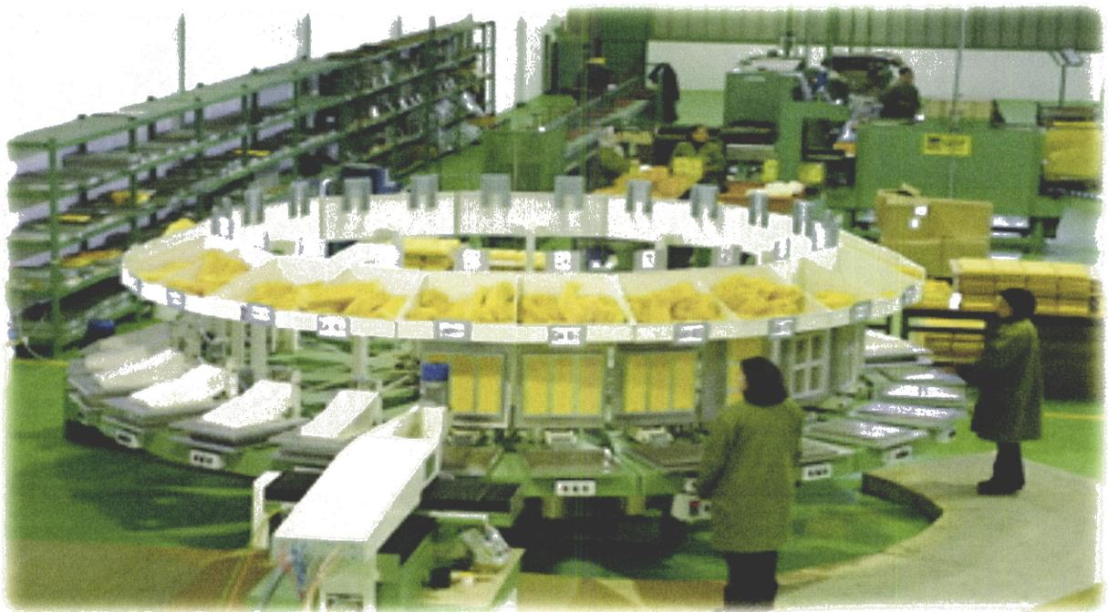
Carrousel programmable pour la fabrication des filtres à air panneaux
